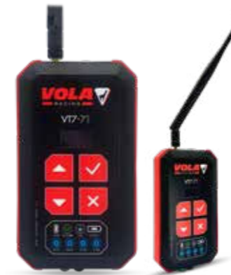
Radio de transmission d'impulsions Ref VT7-71 > portée de 5km. > 4 canaux avec fiches bananes. > 1 départ + 3 inter OU 1 départ + 2 inter + 1 arrivée. > 3 relais possibles, avec intermédiaires (retard fixe 200ms).
